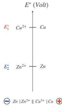
Calcul de la force électromotrice à vide ( $i = 0 = dq$  d'où  $\delta W_{elec} = 0$ ) pour  $[Cu^{2+}] = [Zn^{2+}] = 10^{-1} \text{ mol} \cdot L^{-1}$ :
