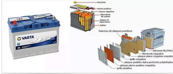
Les modèles de batterie qui équipent nos voitures, permettent le stockage de l'électricité nécessaire au démarrage du moteur et au fonctionnement des équipements électriques. Elles sont constituées de plusieurs accumulateurs au plomb-acide, six, exactement, pour les modèles les plus courants en 12 Volts, soit 6 de 2 Volts, approximativement, chacun.
