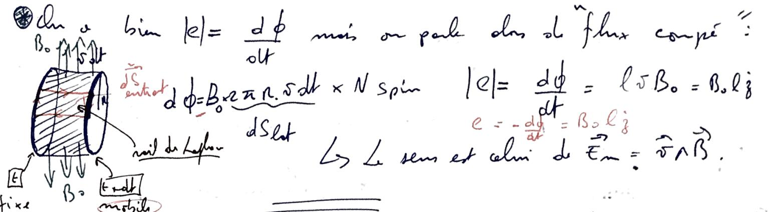
ex<sup>o</sup> électrique: On utilise un modèle de circuit.
