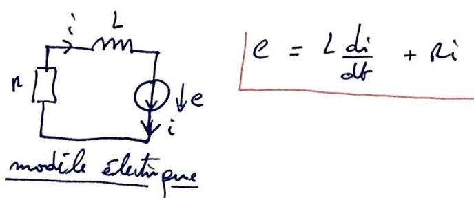
$$\underline{\text{éq° électrique: }} e = - \frac{d\phi}{dt} \text{ ou } \phi = \vec{B}_0 \cdot \vec{S} = z_0 H B_0 \cos(\omega t)$$
