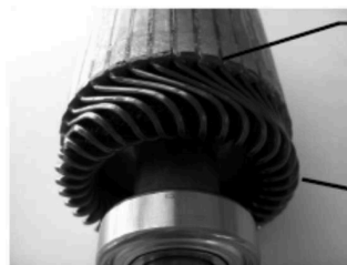
Fig.6 : Encoches du rotor d'une machine à courant continu
