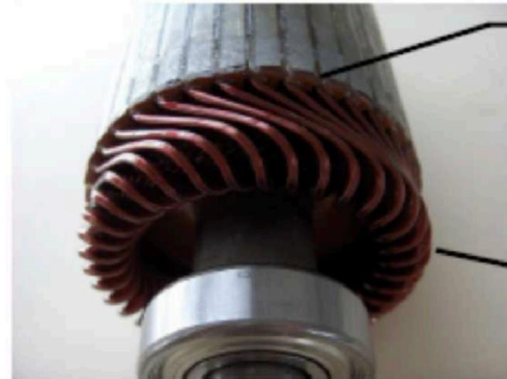
Encoche du rotor qui accueille les sections de l'enroulement d'induit.
