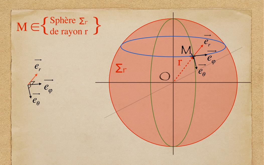
$\overline{e_r}( heta, oldsymbol{\phi})$  indique dans quelle direction r augmente
