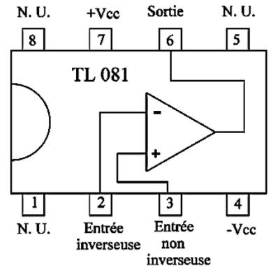
RQ : la masse n'y apparait pas mais correspond au 0V de l'échelle définie par 4 et 7 (+/- 15 V)
