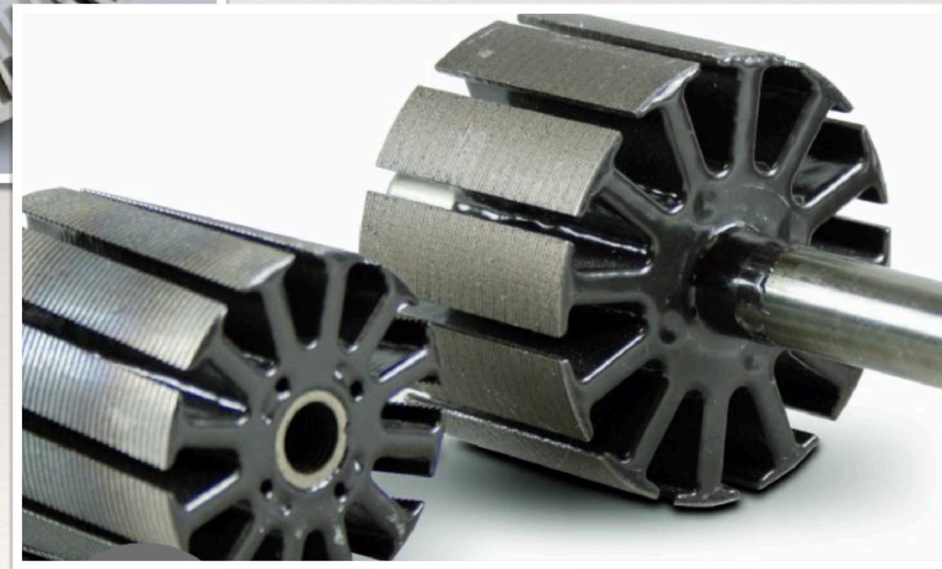
**Isolation** de paquets de tôles avant le bobinage
