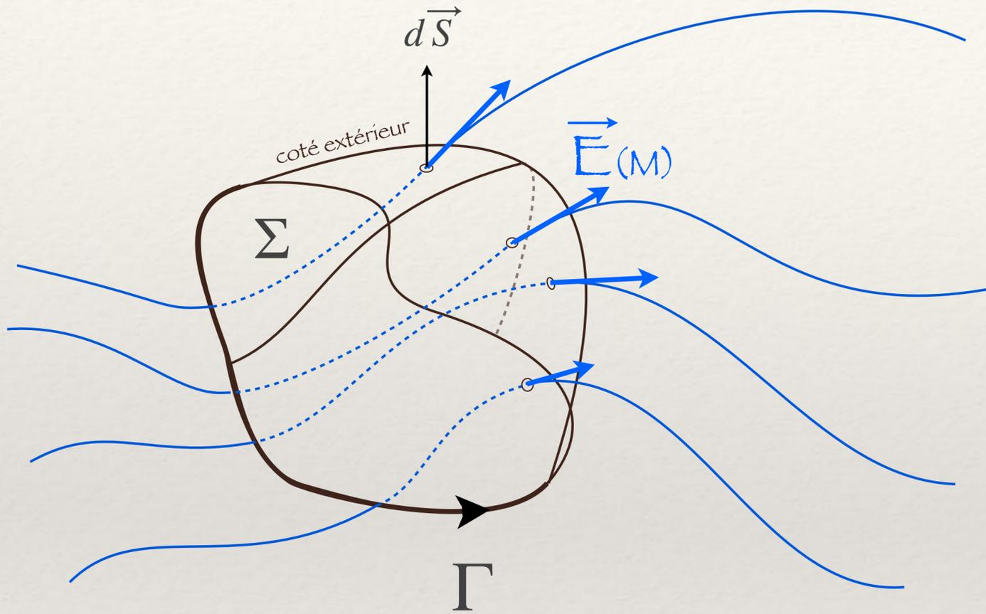
Le flux dépend de  $\Gamma$  et non de la surface elle-même  $\Sigma$  :
