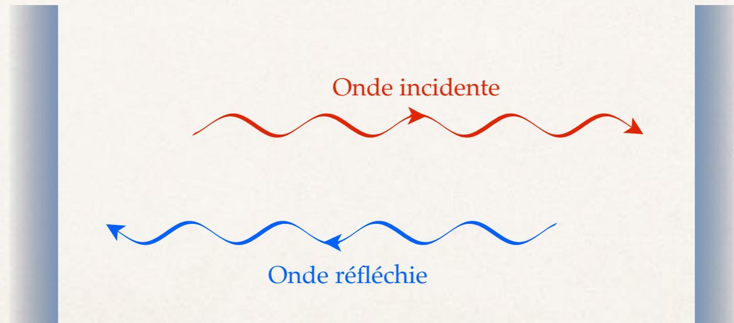
→ Le principe de superposition nous permet de traiter le pb. comme la superposition de deux ondes progressives en sens inverse.
