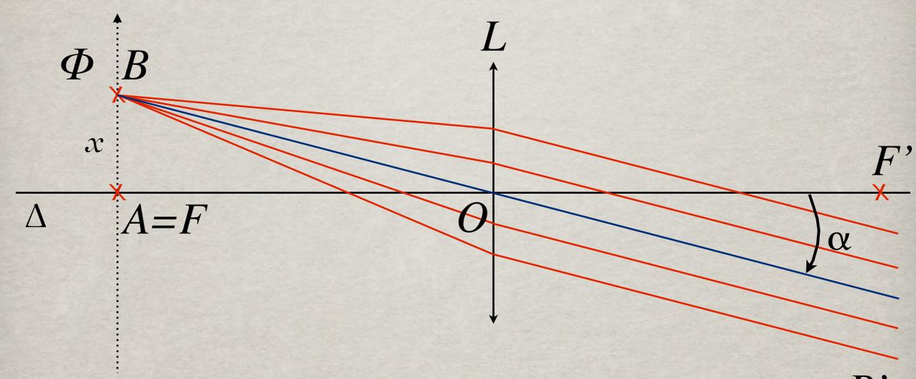
A chaque position x de l'objet dans le plan focal correspond une direction de l'image à l'infini, caractérisée par son angle  $\alpha$  (ici  $\alpha$  < 0)
